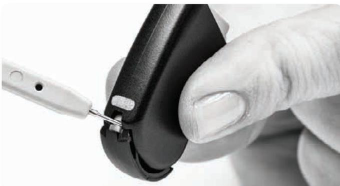
Deje la herramienta a un lado. Ahora, puede tomar el compartimento de baterías de zinc-aire con la mano y tirar de él suavemente para terminar de abrirlo, de modo que pueda insertar las celdas de zinc-aire.
